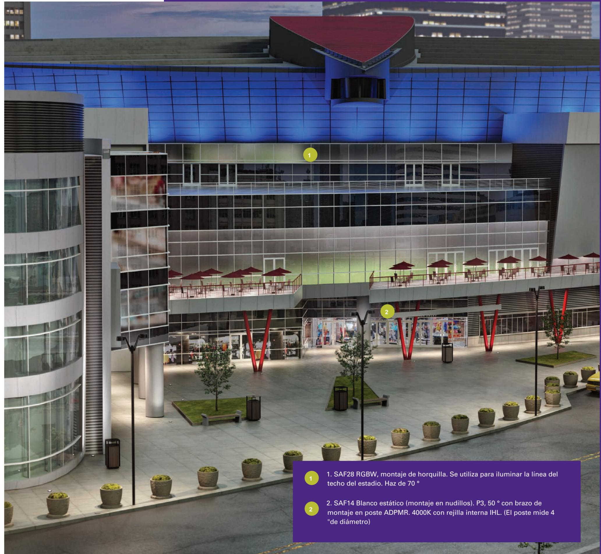
1. SAF28 RGBW, montaje de horquilla. Se utiliza para iluminar la línea del techo del estadio. Haz de 70°
