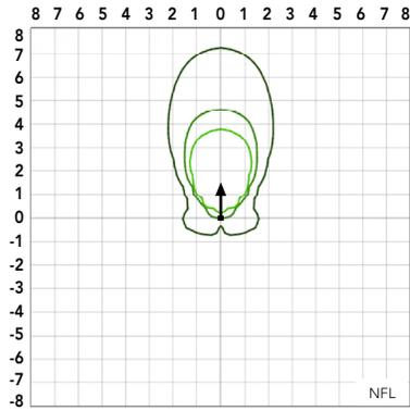
HLF2 LED P4 50K- Luminarios inclinados a 80° a una altura de montaje de 30ft
