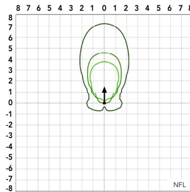
HLF1 LED P3 50K - Inclinación del luminario a 80° a 9 metros de altura de montaje
