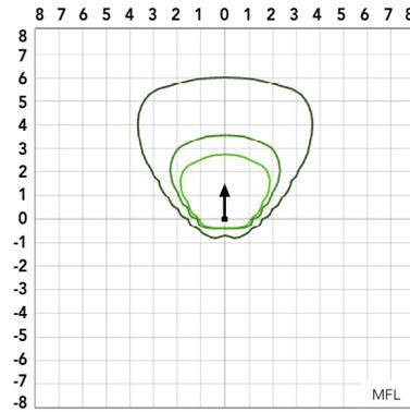
HLF2 LED P4 50K - Luminarios inclinados a 60° a una altura de montaje de 40ft
