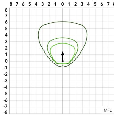
HLF1 LED P3 50K - Inclinación del luminario a 60° a 9 metros de altura de montaje
